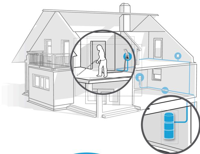
*Ihr Retraflex®-System nutzt das gleiche Rohrsystem, wie Ihr traditioneller Zentralstaubsauger. Retraflex kann auch mit anderen Saugdosen und Zubehör kombiniert werden.*
