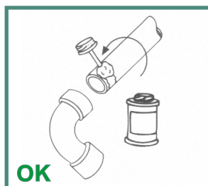
Abb. 2: Kleber, niemals in die Muffe.
